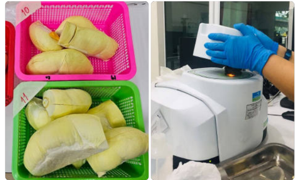
ภาพที่ 5: เป้าหมายที่ 2 การให้บริการตรวจวิเคราะห์ความอ่อน-แก่ของทุเรียนด้วยเทคโนโลยี FT-NIR Spectroscopy
